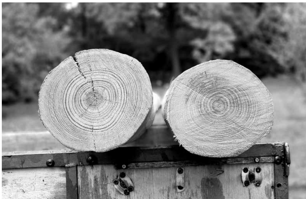
Immagine 2 – Tondame di castagno per pali: quello a sinistra si è fessurato, al contrario di quello di destra, tagliato nello stesso luogo ma a una settimana di distanza (con luna calante in pesci).
