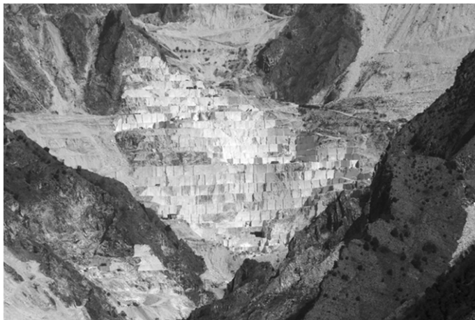
Un fronte di cava: altezza media di ogni "bancata", 6-9 metri (si noti la casa a due piani sulla sinistra).
